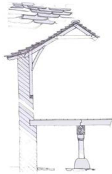
Figure 30 : Vue en coupe de la charpente pour les toits de lauze.
